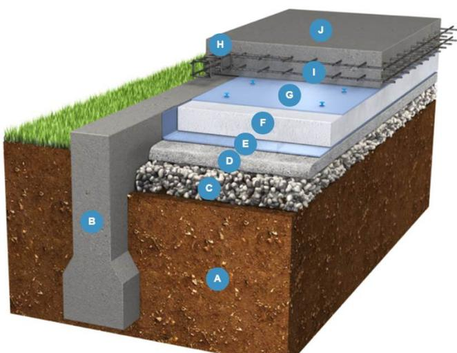
L'isolant joue le rôle de coffrage perdu et est soumis au poids propre de la dalle uniquement lors du coulage et du séchage pour un délai de quelques jours.
