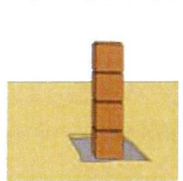
Afin de remplir le pilier, déversez-y du béton, par couches successives d'environ 80 cm de hauteur.
